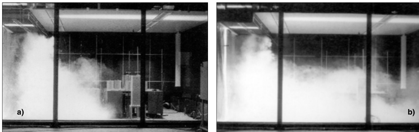
Rys. 2. Rozprzestrzenianie się powietrza przy zastosowaniu systemu INDIVENT
